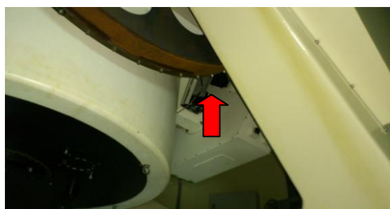
図 7. Andor DU-440 BV のシャッターとコントローラーの位置
