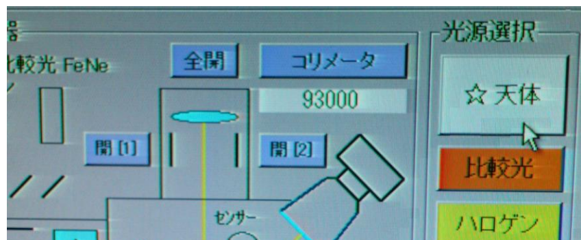
図 13. Spgops のコリメータ、ハルトマンシャッター開閉部分の拡大
