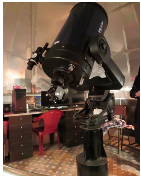
図7：アディーブ天文台のシュミット・カセグレン望遠鏡
